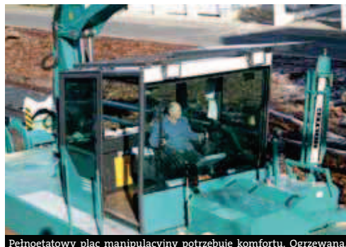
Pełnoetapowy plac manipulacyjny potrzebuje komfortu. Ogrzewana, przejrzysta, kabina umożliwia pewniejsze działania w każdej sytuacji. Fot. Baljer & Zembrod
