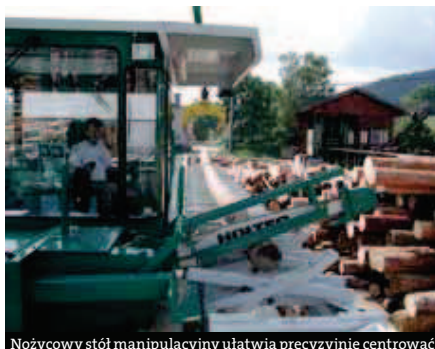
Nożycowy stół manipulacyjny ułatwia precyzyjnie centrować na żurawiu. Następnie wykonywany jest dokładny pomiar długości i średnicy danej sztuki. Operator widzi na monitorze obraz przekroju sztuki drewna, a więc wady, tj. krzywizny, guzy oraz wszystkie jej parametry, takie jak długość i średnica. Następnie za pomocą programu komputerowego operator sprawdza maksymalne wykorzystanie dłużycy odpowiednio wg listy zamówień, optymalizuje rozkroj i manipuluje daną sztukę na kłody o określonej długości. Odmowa zalet tego typu manipulacji jest dokładny pomiar dłużycy, za pomocą którego można maksymalnie wykorzystać jej długość i objętość. Operator nie musi szacować i zastanawiać się, jakiej długości z danej dłużycy jest w stanie wymanipulować kłody, ponieważ sprawdza symulacją komputerową za każdym razem różne warianty, a więc jest w 100 % pewien, ile i jakiej długości kłody mogą zostać wymanipulowane. System pomiarowy zwany „pomocą rozdziału” gwarantuje ekonomiczny zestaw kłód. Operator po rozcięciu, żurawiem transportuje i rozsortowuje kłody do określonych boksów.
